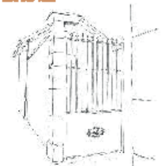
Mur et pile maçonnés avec portail en ferronnerie déposé en feuillure
