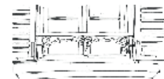
Appui de fenêtre en pierre recadrant, volets, lisse de garde-corps en bois et ferroment
