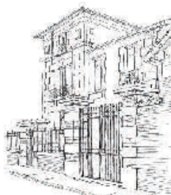
Grilles, portillon et portail en ferronnerie entre piles de briques et pierre en alternance, soit en lacis avec l'architecture des villes
