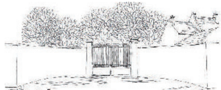
Portail en ferronnerie accolé par des piles en pierre, en retrait dans les murs de rocaille existant, en direct face
